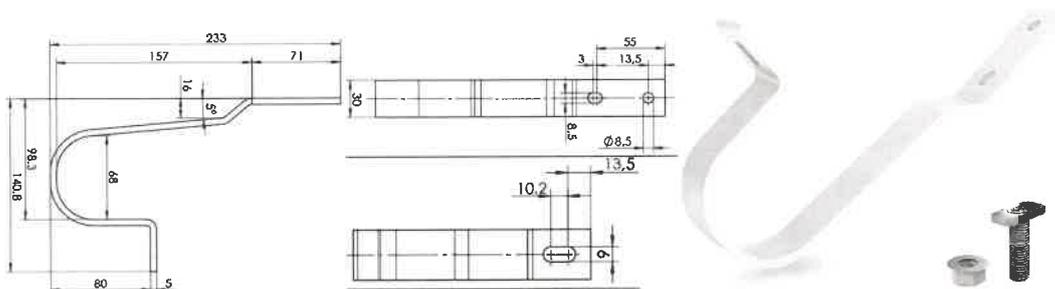
Crochet en acier inoxydable pour la fixation du SingleRail sur tuiles plates. Y compris vis à tête marteau (acier inox A2) et écrous à embase avec cran d'arrêt (acier inox A2) - Matériau : Acier Inox
